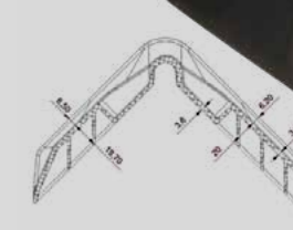
Ángulos para la protección de los amarres de carga, evita daños tanto en el amarre como en la mercancía. Fabricado en Polipropileno copolímero, robusto y muy flexible.
